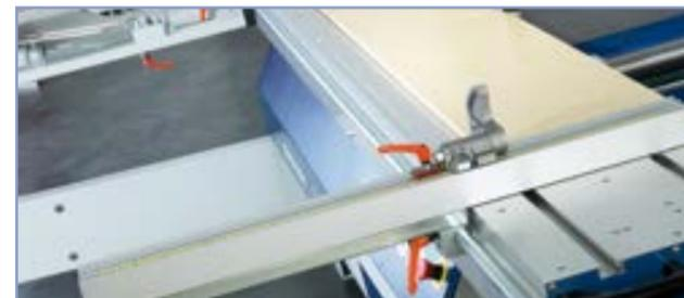
Auf dem Rollwagen verschiebbarer Anschlag zum Schneiden langer schmaler Streifen mit einer Schnittbreite bis 800 mm.
