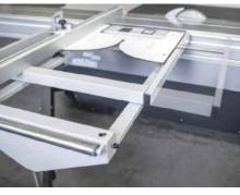
Der ausziehbare Teleskoprahmen passt sich der Werkstückgröße an
