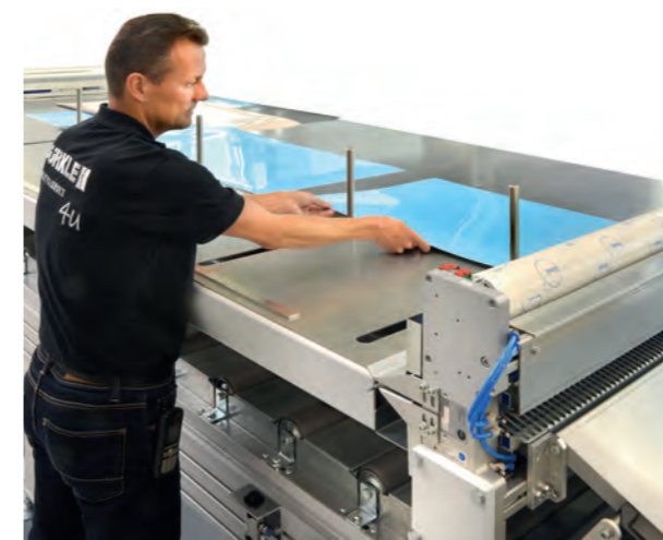
Legestation mit Reinigungseinrichtung (optional) zum Legen der Bögen (bei Bogenware) in Längsrichtung. Lay-up area with cleaning unit (optional) to lay up the sheets in longitudinal direction.
