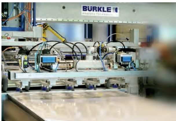
Automatische Auflage des Beschichtungsmaterials Automatic placement of the surface material
