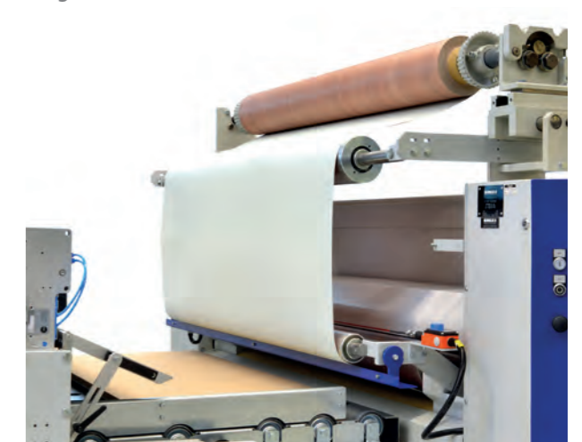
Abwickelstation für Kaschierbetrieb von der Rolle. Uncoiling unit for lamination of coiled material.
