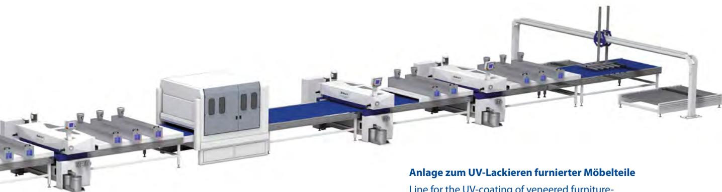
**Anlage zum UV-Lackieren furnierter Möbelteile**
